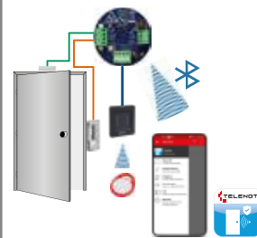
Tür mit Türmodul iBLUE uP und RFID-Schreib-Leser cryplock BLM10 H5B
